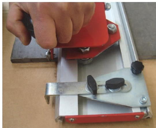
Для использования присоски поверхность керамической плитки должна быть гладкая (рис.4). Рез плитки необходимо осуществлять от начальной точки плитки до конечной с одинаковой скоростью. Для разлома плитки необходимо закрутить барабашек на разламывателе плитки (рис.5). Разлом нужно производить в начале и конце плитки.
