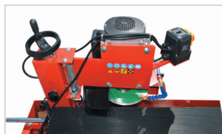
Настройка угла реза под 45°
